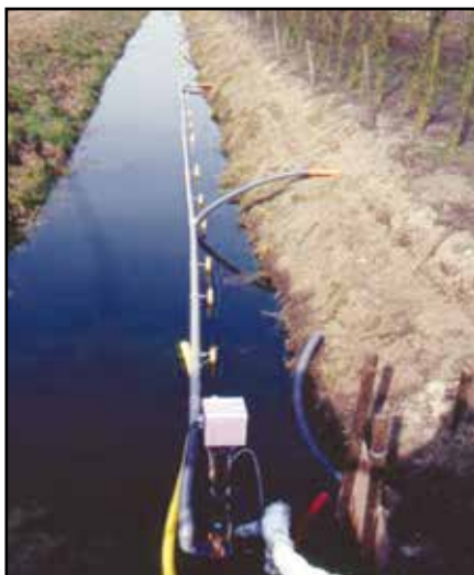
Recherche sur le terrain de la décharge de produits chimiques par des drains souterrains sous les pommiers par rapport à l'application
